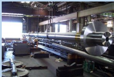
プロペラ軸 19,900L 材質 KSF60
