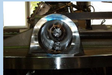
バタフライ弁 素材寸法 40t/180t×φ1082 加工寸法 Φ125 材質 SCS13
