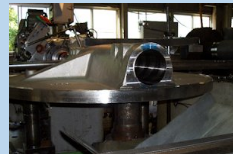
バタフライ弁 素材寸法 40t/180t×φ1082 加工寸法 Φ125 材質 SCS13
