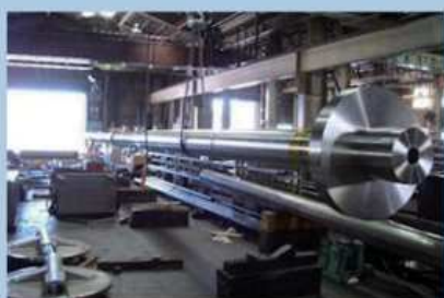
プロペラ軸 19,900L 材質 KSF60
